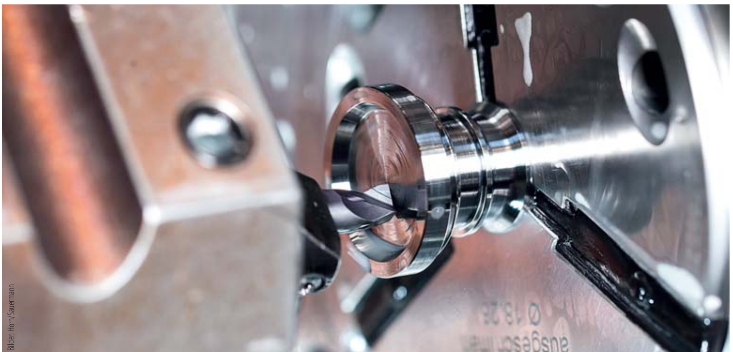
Plandrehen des Axialeinstichs mit dem Supermini 105.
