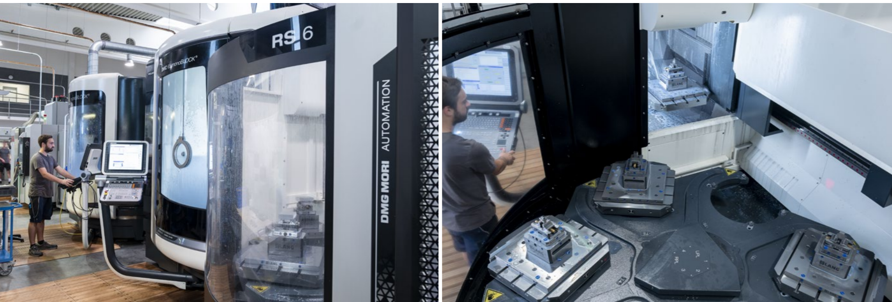
Insbesondere in der hochpräzisen Kleinserienfertigung spielen die beiden DMU 65 monoBLOCK mit RPS 6 ihre Stärke aus.
